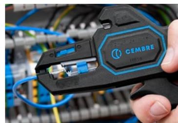
Curseur de réglage de la profondeur de coupe pour définir la hauteur de la lame en fonction des épaisseurs d'isolant
